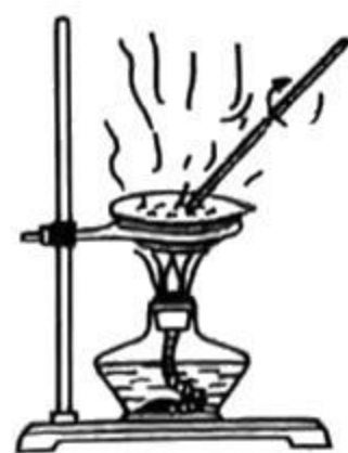
B. 提纯含少量 NaCl 杂质的粗苯甲酸
